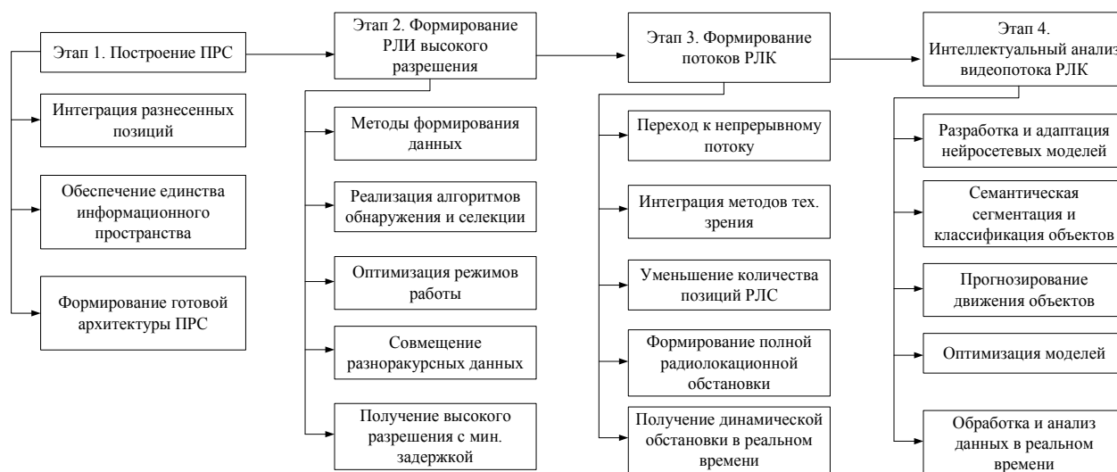
Рис. 2. Этапы реализации освещения передней зоны в рамках реализации новой концепции групповой авиационной системы технического зрения
