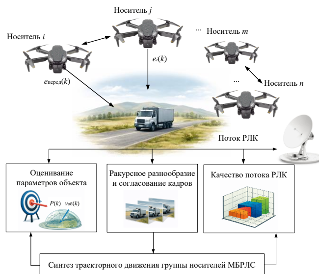
Рисунок 1 – Схема задачи траекторного управления движением группы носителей МБРЛС при формировании потока РЛК
