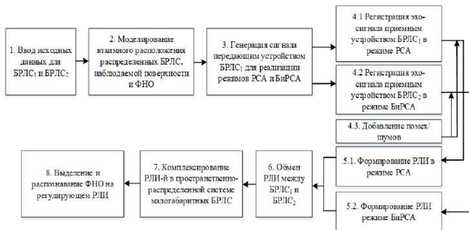
Рис. 1. Схема моделирования процесса функционирования двухпозиционной пространственно-распределенной системы малогабаритных БРЛС при наблюдении за земной поверхностью в целях получения высокоточного результирующего РЛИ
