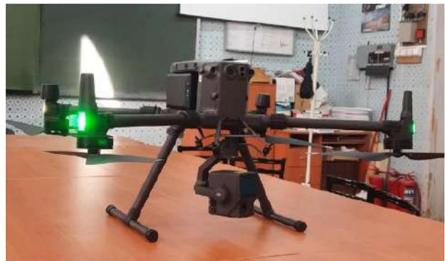
Рис. 2. Платформа Matrice 300 RTK с модулем Zenmuse L1, закрепленным снизу
