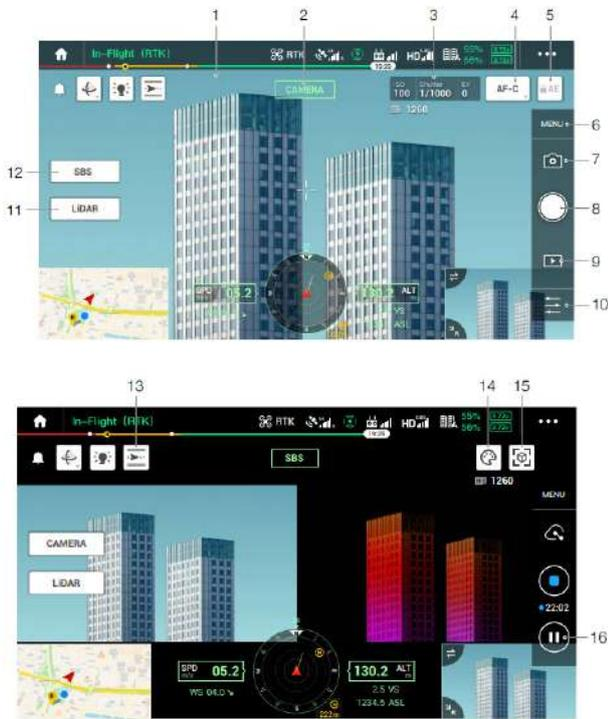
Рис. 5. Интерфейс экрана DJI Smart Controller Enterprise
