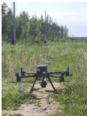
Рис. 7. МЛА Matrice 300 RTK с модулем Zenmuse L1 на взлетно-посадочной площадке
